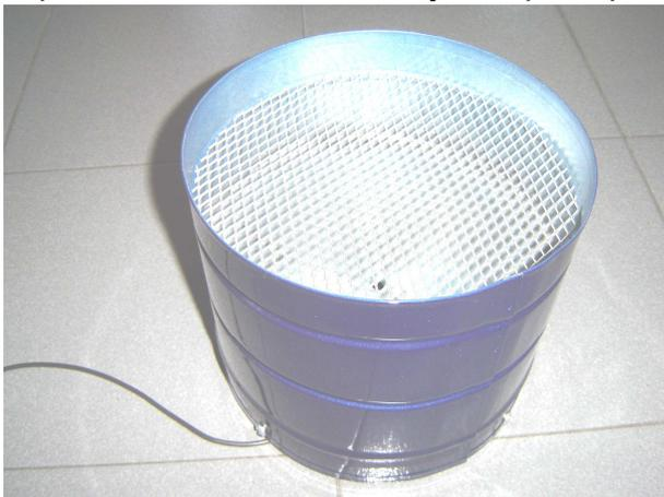
Está construido en chapa galvanizada y pintura epoxi horneada.
