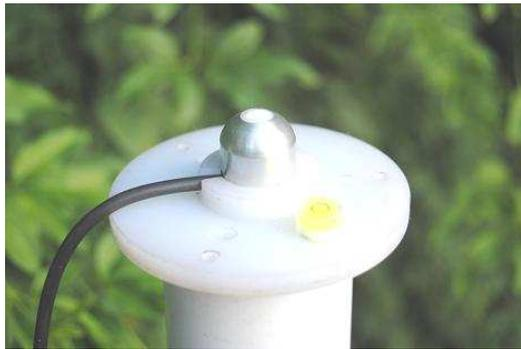
El sensor de radiación PAR está compuesto por una celda de GaAsP que posee una respuesta espectral en la banda comprendida entre los 400 y los 700 nm de longitud de onda.
