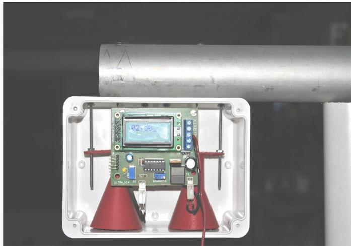
El sensor de altura de mar/río funciona por radar/ultrasonido. Se emite una onda que choca contra el agua y retorna. La velocidad de la onda es conocida, resta averiguar el tiempo que le lleva a la onda recorrer la distancia.
